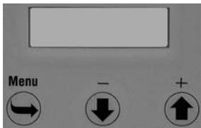
Netzschalter einschalten und gleichzeitig (Menu)-Taste betätigen und nach aufhellen des Displays loslassen.
