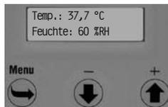
Netzschalter einschalten und gleichzeitig (+)-Taste betätigen und nach aufhellen des Displays loslassen.
