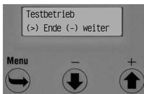
Mit der (Menu)-Taste wird das Menü für den Testbetrieb verlassen. Mit der (-)-Taste wird der Testbetrieb gestartet. Dabei wird bei jedem Betätigen der (-)-Taste jeder Ausgang, beginnend mit der Temperatur, einzeln angesteuert.
